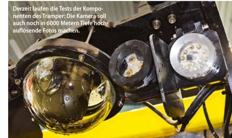
Derzeit laufen die Tests der Komponenten des Trampers: Die Kamera soll auch noch in 6000 Metern Tiefe hochauflösende Fotos machen.
